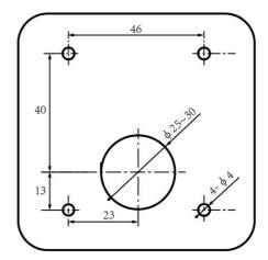
(2) 按照下图所示将先将产品后壳拆下固定到操纵盘上,拧紧螺丝。
