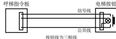
通常电梯按钮线路结构为以上两种形式，查看电梯按钮接线方式是三线还是四线，三线按钮且按钮数量超过两个不适合本产品，请选择分层型控制器。
